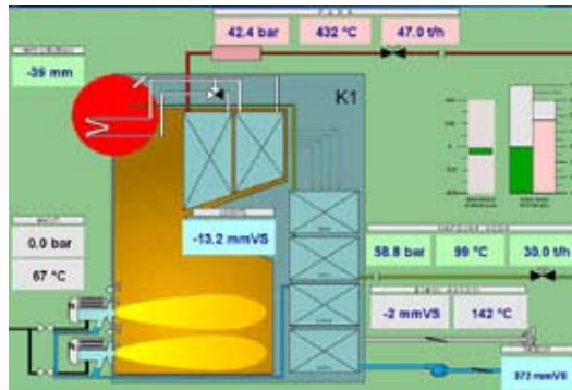
slika 2: Monitorski ekran strmocevnog kotla
